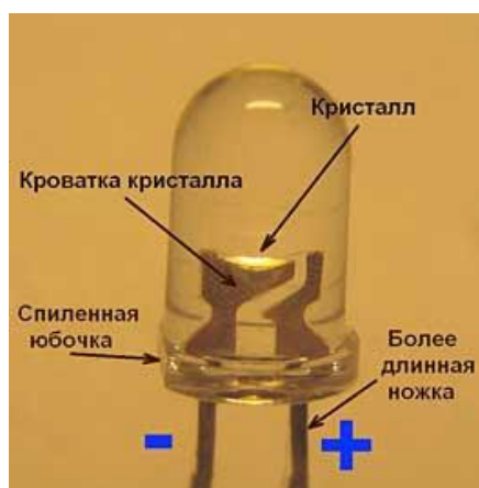
Рисунок 5.1- Конструкция светодиода
