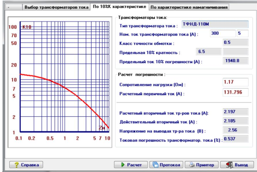
Рисунок Б.1 – Определение токовой погрешности ТТ на стороне 110 кВ
