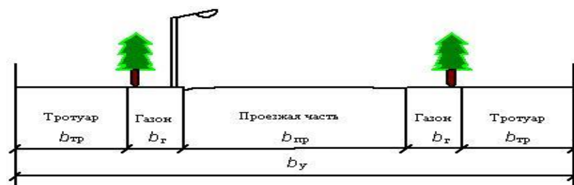
Рисунок 5.1 - Поперечный профиль проезжей части
