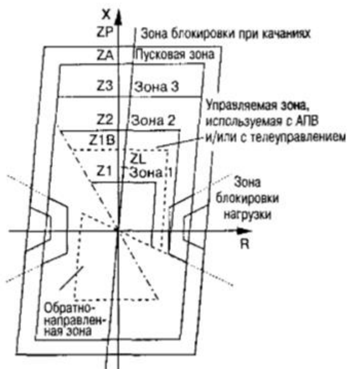
Рисунок 4.8 – Зоны цифровой дистанционной защиты «Зонно-зависимая» логика
