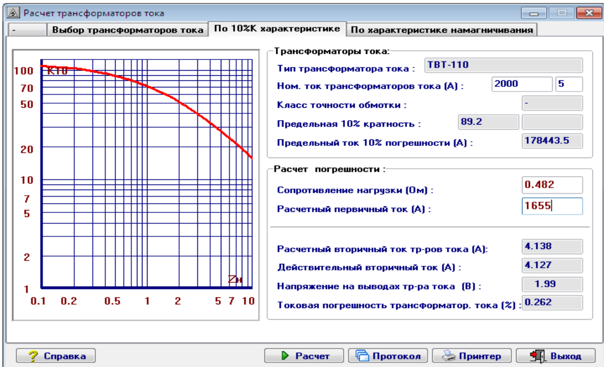
Рисунок Б.4 - Расчет погрешности TBT-110-2000/5
