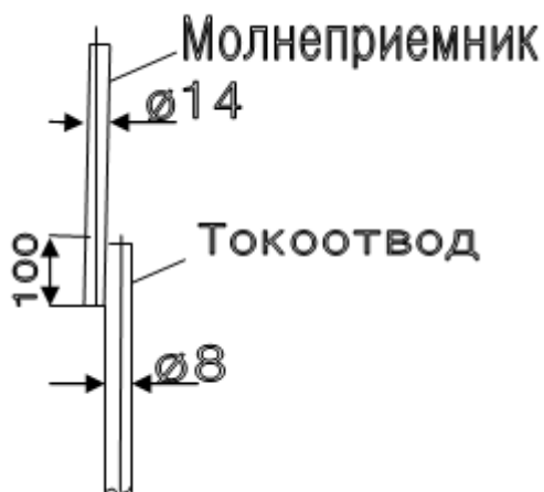
Рисунок 20.7 - Конструкция молниеприемника из круглой стали
