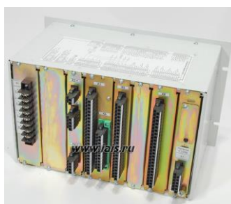
Рисунок 5.6 - Модульная мультипроцессорная архитектура
