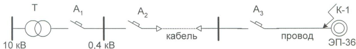
Рисунок 7.5 – Схема питающей линии для ЭП Определяем токи нагрузки:
