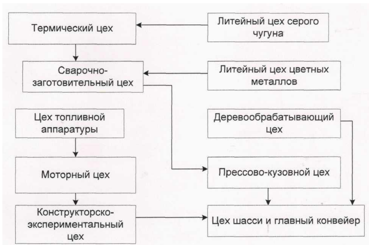
Рисунок 1.1 – Технологическая схема выпуска тяжелых машин
