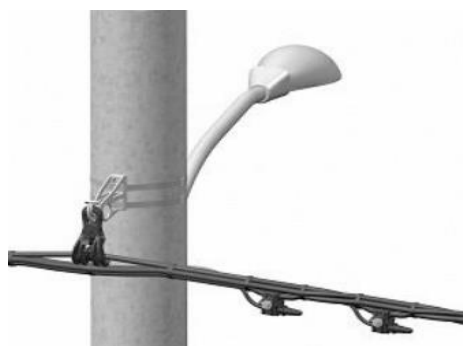
Рисунок 2.3 – Подключение проводника СИП-4 к столбу внешнего освещения
