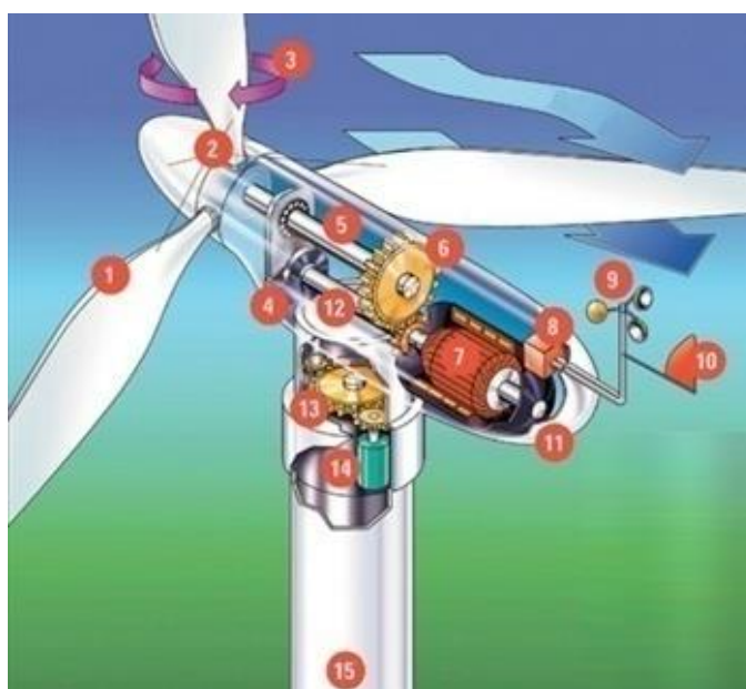
Рисунок 4.2 – Устройство ветряной установки
