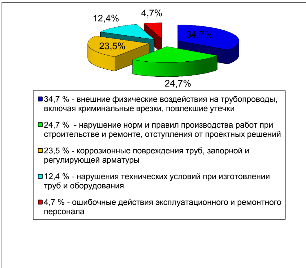
Рисунок 2.4 - Основные причины аварий на объектах магистральных трубопроводов
