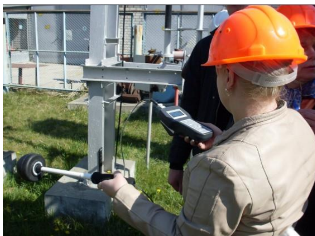
Рисунок 3.2 – Процесс проведения измерений напряженности ЭМП при помощи прибора VE-50
