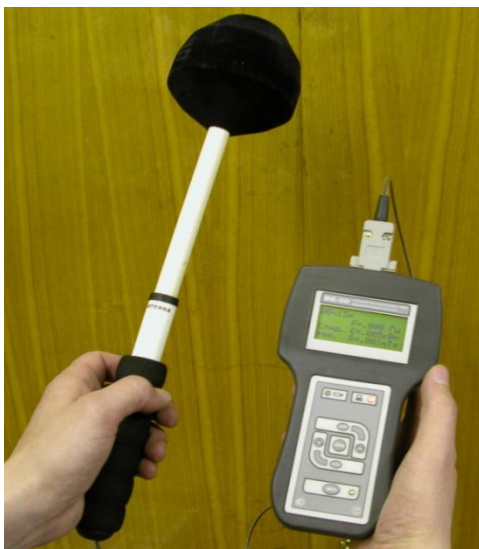
Рисунок 3.1- Измеритель параметров ЭМП промышленной частоты ВЕ-50
