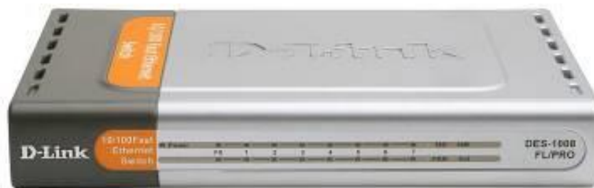
Сурет 1.5 – D-link DES-1008FL/PRO коммутаторының сыртқы көрінісі
