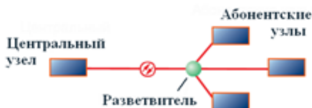
Рисунок 1.4 – Топология «дерево с пассивным оптическим разветвлением»
