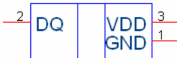
2.17 Сурет - DS18B20 микросхемасының шартты белгіленуі
