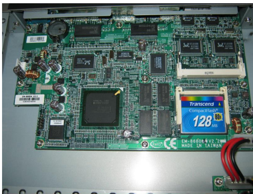
Рисунок 2.10 – D-Link DFL-800E (вид изнутри)
