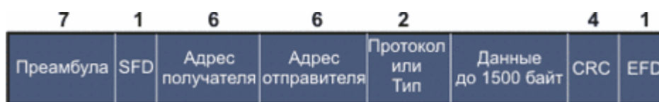
Рисунок 1.1 - Формат кадра сетей Ethernet.
