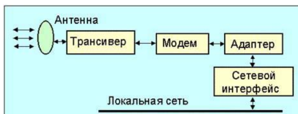
Рисунок 1.9- Схема оборудования радиоканала передачи данных
