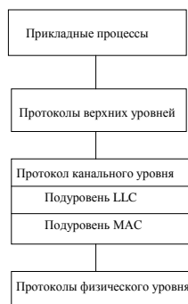
Рисунок 1.10- Алгоритмическая структура беспроводной сети стандарта 802.11
