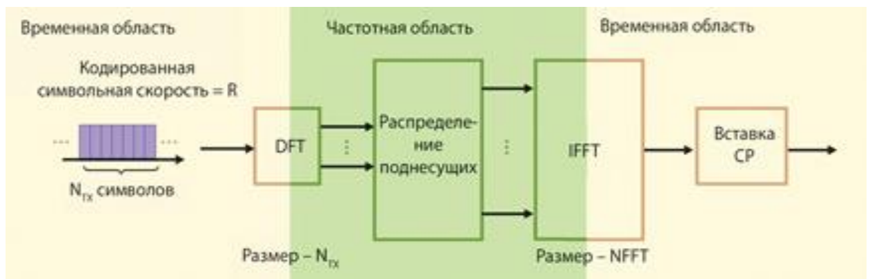
Рисунок 2.7 - Структурная схема генерации сигнала SC-FDMA
