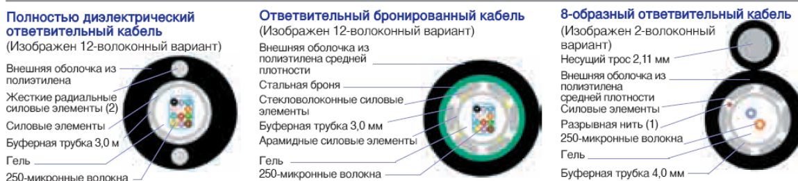
Рисунок 2.6 - Технические характеристики и фотография оптического кабеля
