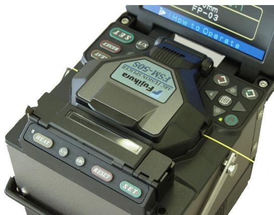
Рисунок 2.10 - Сварка оптического волокна
