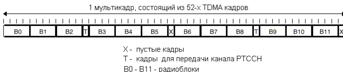
Рисунок 1.2 – 52-х кадровый мультикадр, используемый в GPRS
