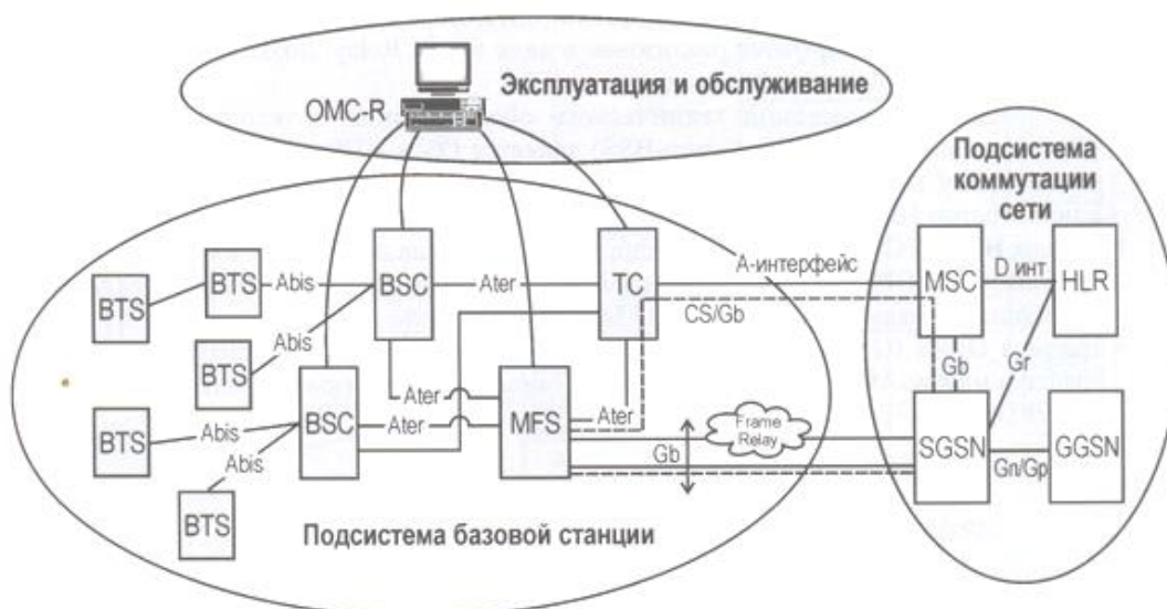
Рисунок 2.7 – Интерфейсы между оборудованием GPRS
