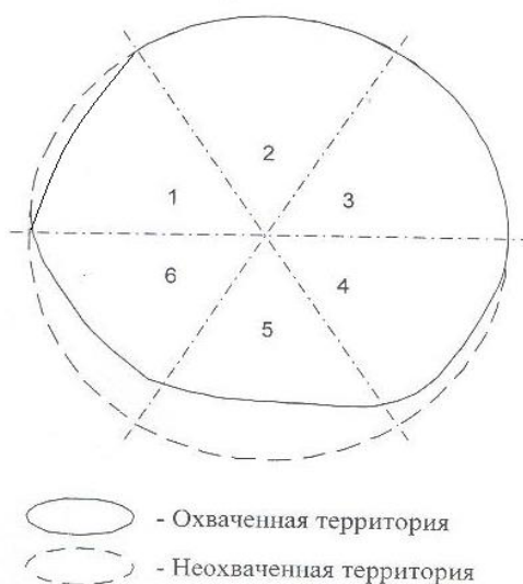
Рисунок 3.3 – Зоны покрытия базовых станций.
