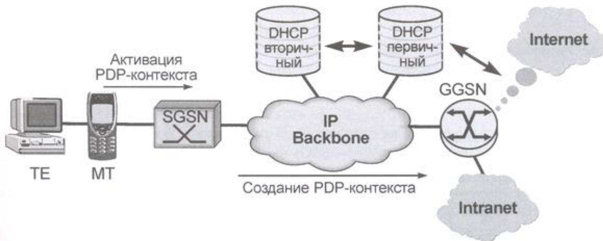
Рисунок 2.18 – Режим прозрачного удаленного доступа
