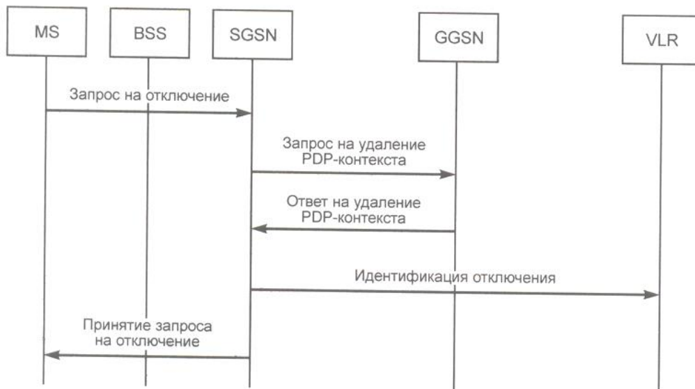
Рисунок 2.3 – Процедура перехода в режим открепления GPRS
