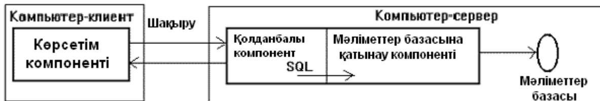
Сурет 1.4.2 Мәліметтер базасы серверінің моделі
