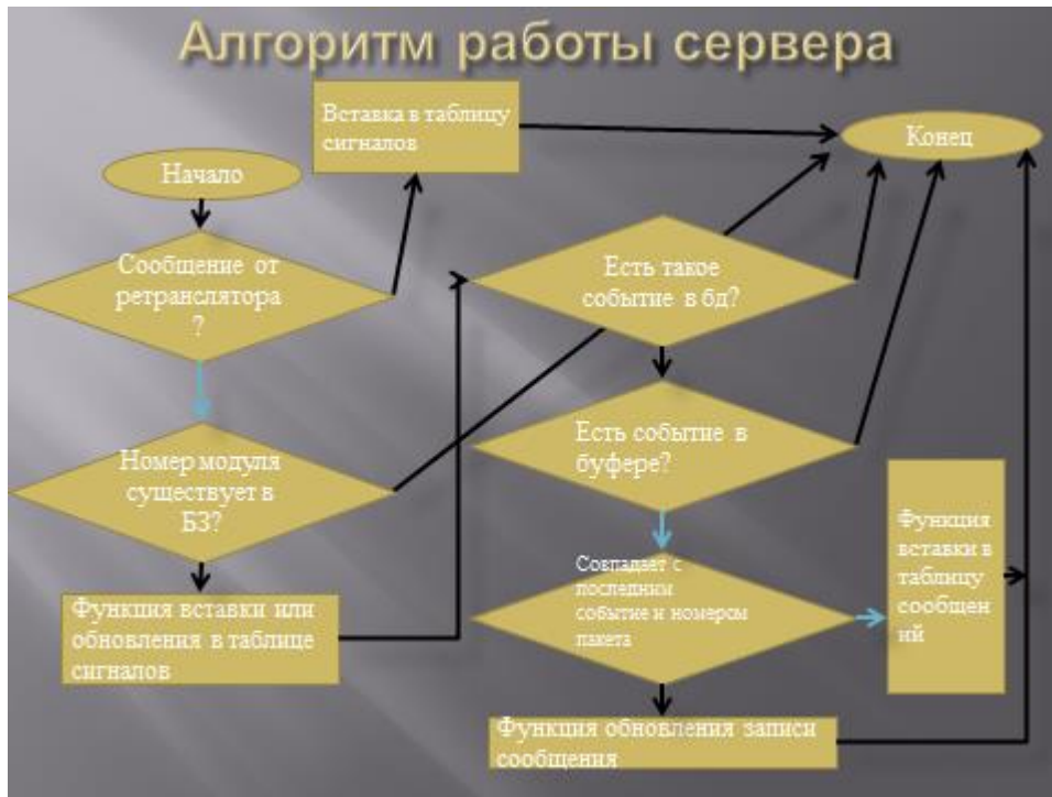
Рисунок 4.1 – Основной алгоритм работы сервера
