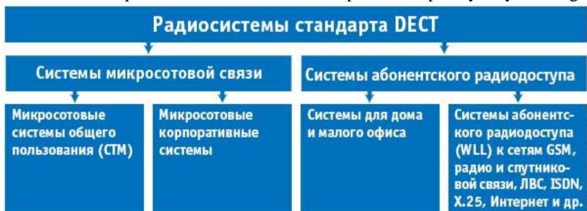
Рис. 6. Функции системы DECT
