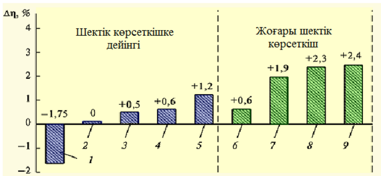
1.8-сурет. БГҚ абсолютті ПӘК-нің өзгерісіне бу турбиналы айналым көрсеткіштерінің әсер етуі (Siemens фирмасының берілгендері бойынша)
