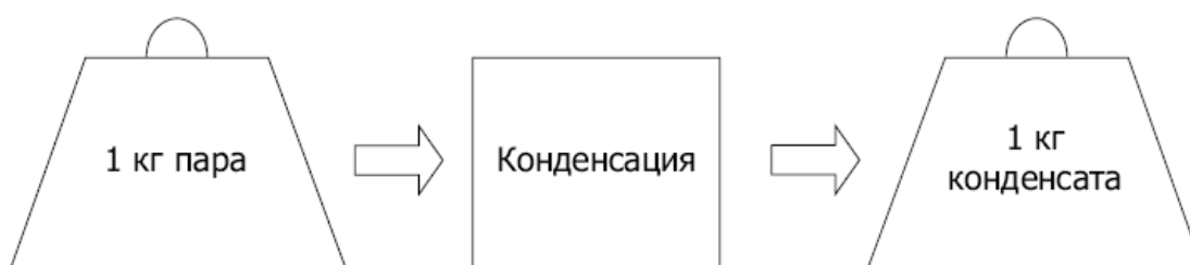
Рисунок 3.3 - 1 кг пара при полной конденсации превращается в 1 кг конденсата
