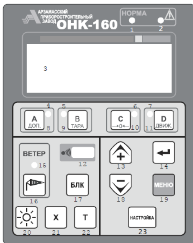
Рисунок 1.3 – Ограничитель нагрузки ОНК-160.Б
