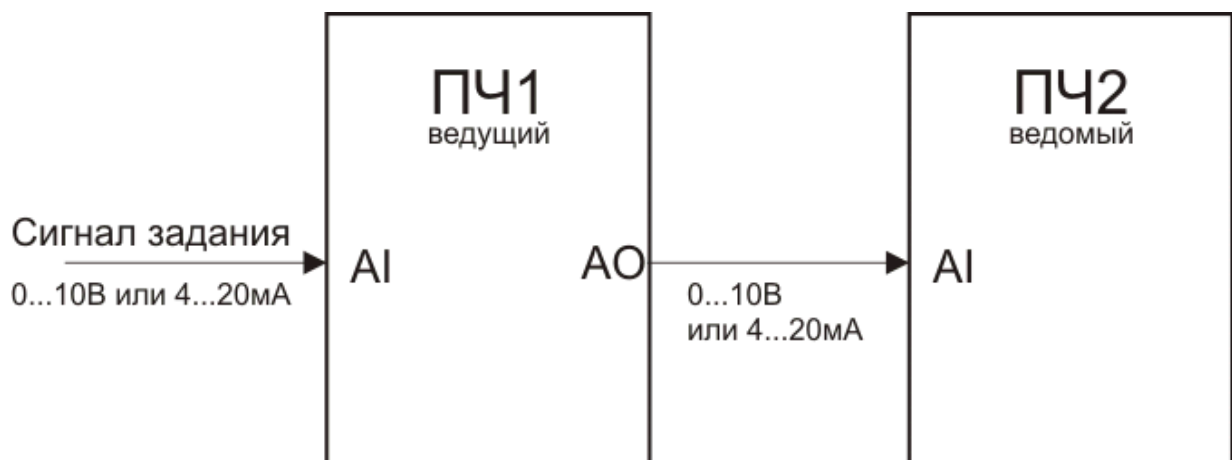
Рисунок 1.6 – Схема синхронизации с помощью ПЧ без датчиков обратной связи.
