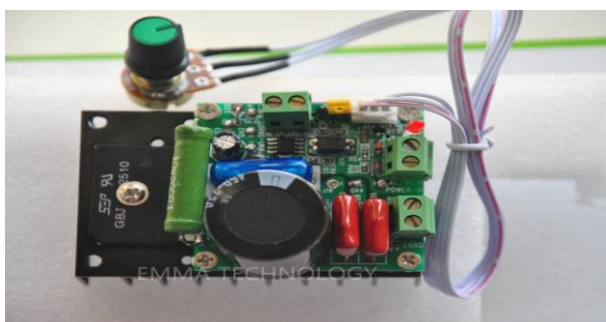
Рисунок 2.9-Широтно-импульсный преобразователь PWMMACH3 SPINDLE 110V
