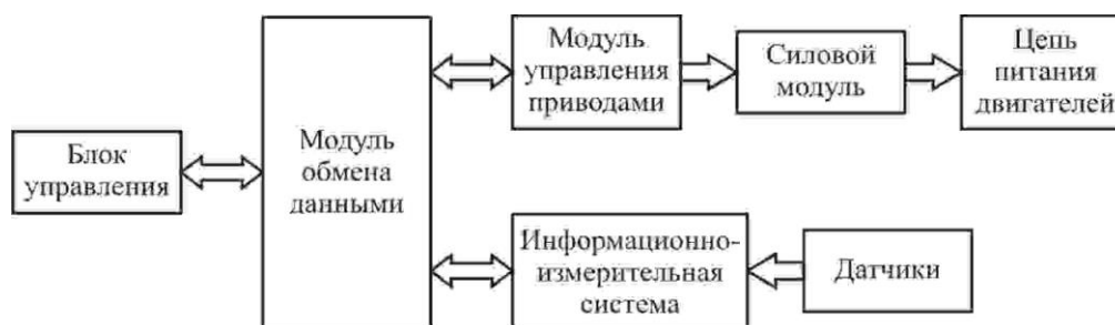
Рисунок 1.18 – Функциональная схема системы управления
