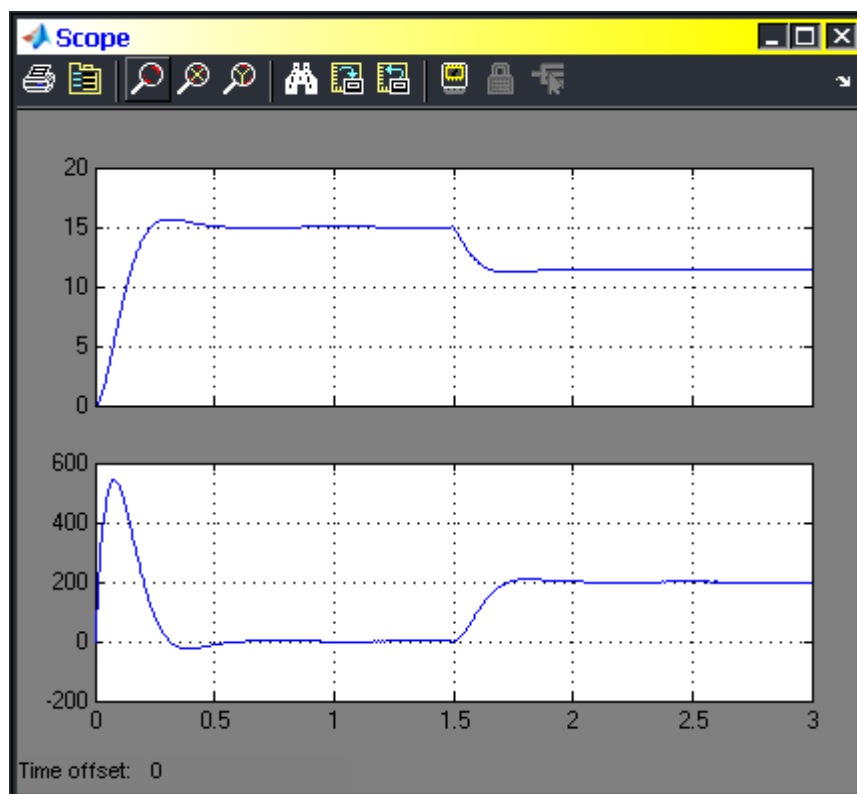
3.7 сурет - Асинхронды қозғалтқыштың тұйықталған ЖТ-АҚ жүйесіндегі жылдамдық пен моменттің өтпелі процесстер қисықтары
