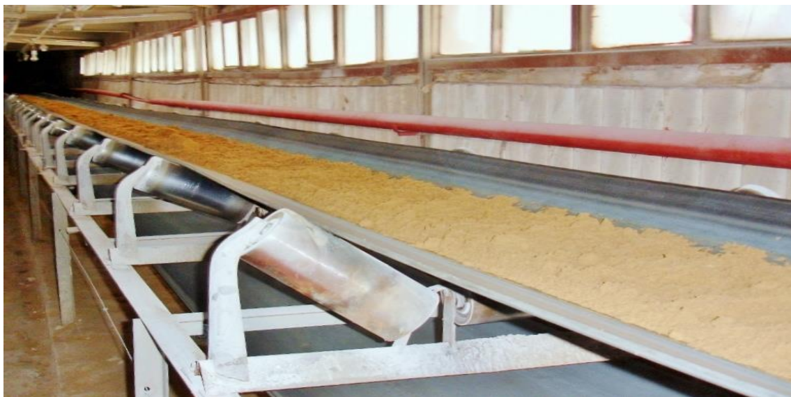
4 сурет – Құм материалын ленталы конвейер арқылы тасымалдау
