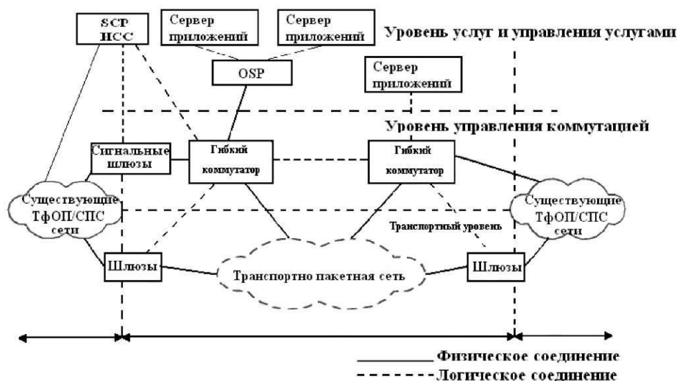
Рисунок 1.1 – Трехуровневая модель сети NGN
