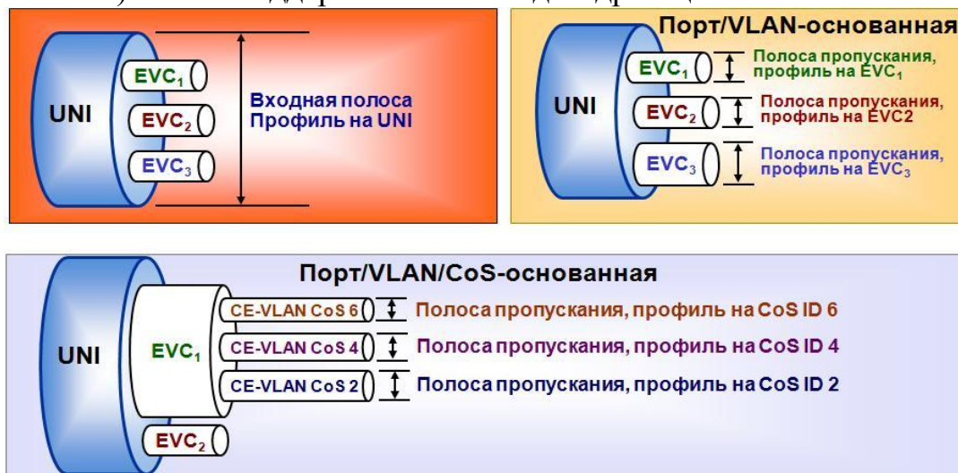
Рисунок 1.13 - Модель управления трафиком на основе номера порта
