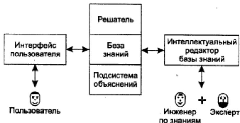
Рисунок 2.1 — Структура экспертной системы
