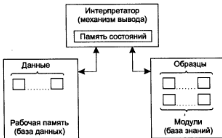
Рисунок 2.3 — Схема функционирования интерпретатора
