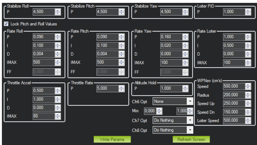
Рисунок 3.45 – Настройка ПИД контроллера полётов
