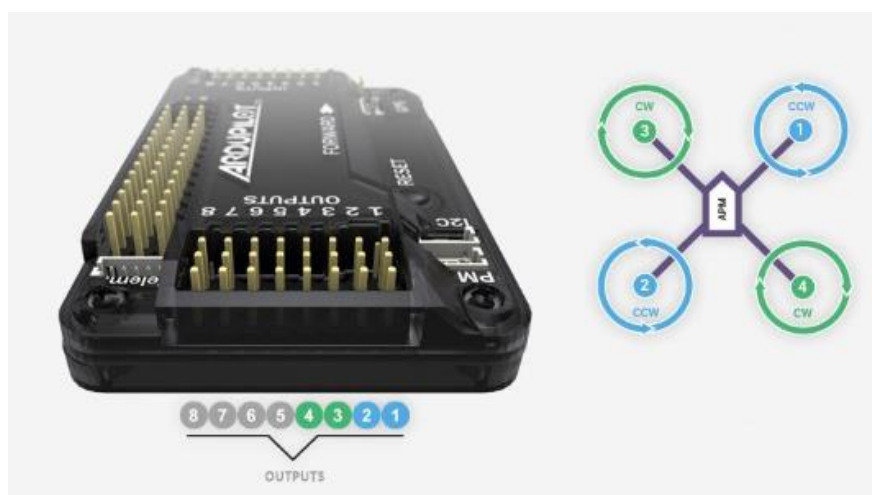
Рисунок 3.40 – Соответствие контактов контроллера расположению моторов
