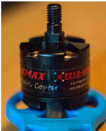
Рисунок 3.32 – Мотор, прикрученный к лучу квадрокоптера
