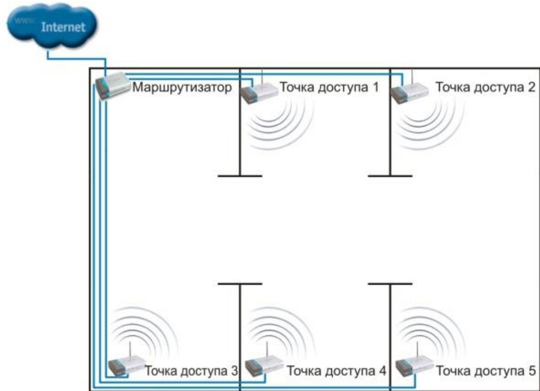
Схема объединения точек доступа через проводную инфраструктуру
