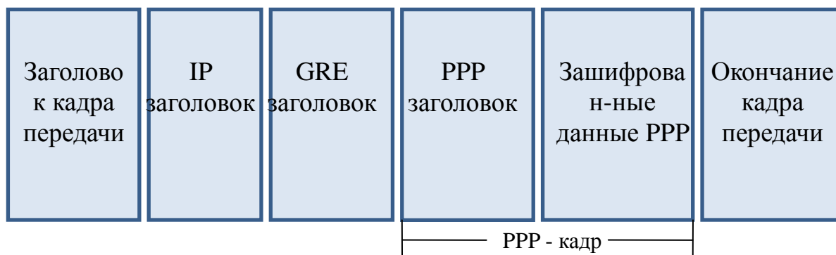
Рисунок 1.5 – Структура данных для пересылки по туннелю PPTP
