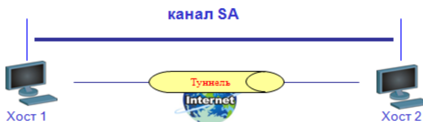
Рисунок 1.7 – Создание канала между двумя точками
