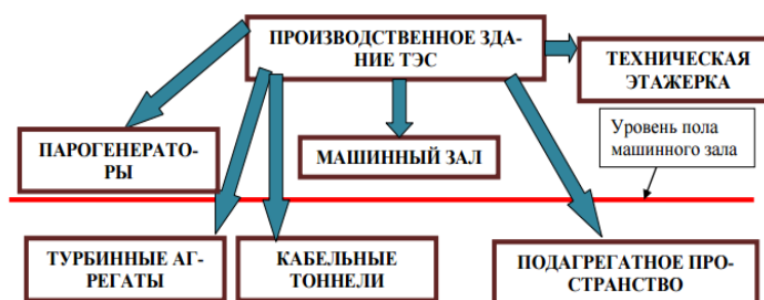
Рисунок 6.1. Основные помещения производственного здания ТЭС [14]
