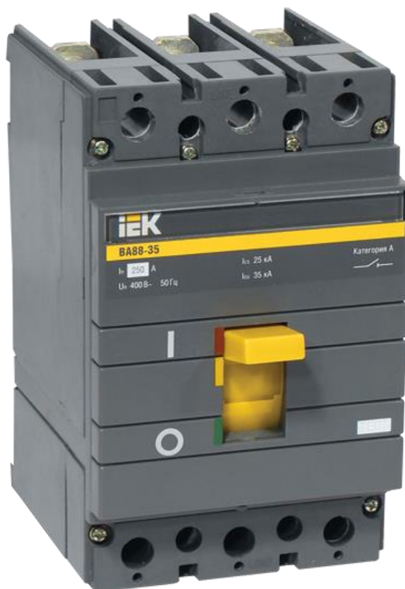
Рисунок 2.5 - Автоматический выключатель ВА88-35 3Р 250А 35кА ИЭК
