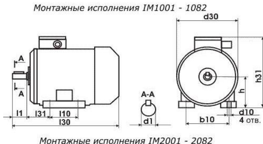
Рисунок 2.5 - Электродвигатель АИР80В4, выполненный в закрытом обдуваемом исполнении
