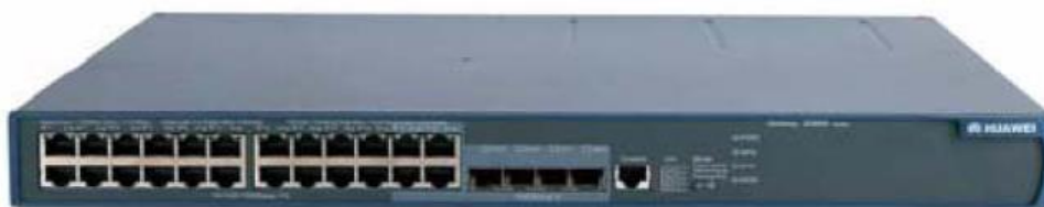
Рисунок 2.22 – Ethernet–коммутатор Quidway S5600 (вид спереди)
