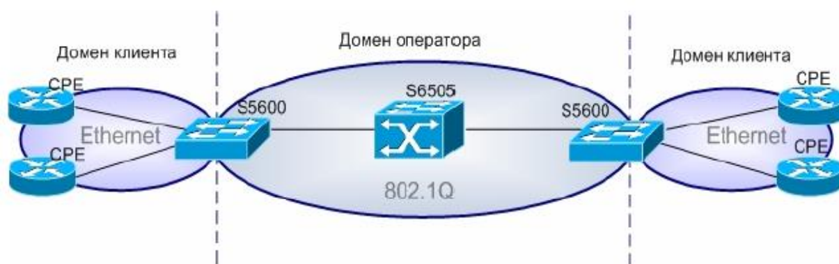
Рисунок 2.5 – Технология 802.Q в сети оператора
