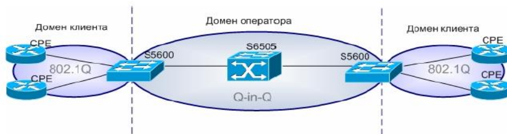
Рисунок 2.7 – Технология Q–in–Q в сети оператора
