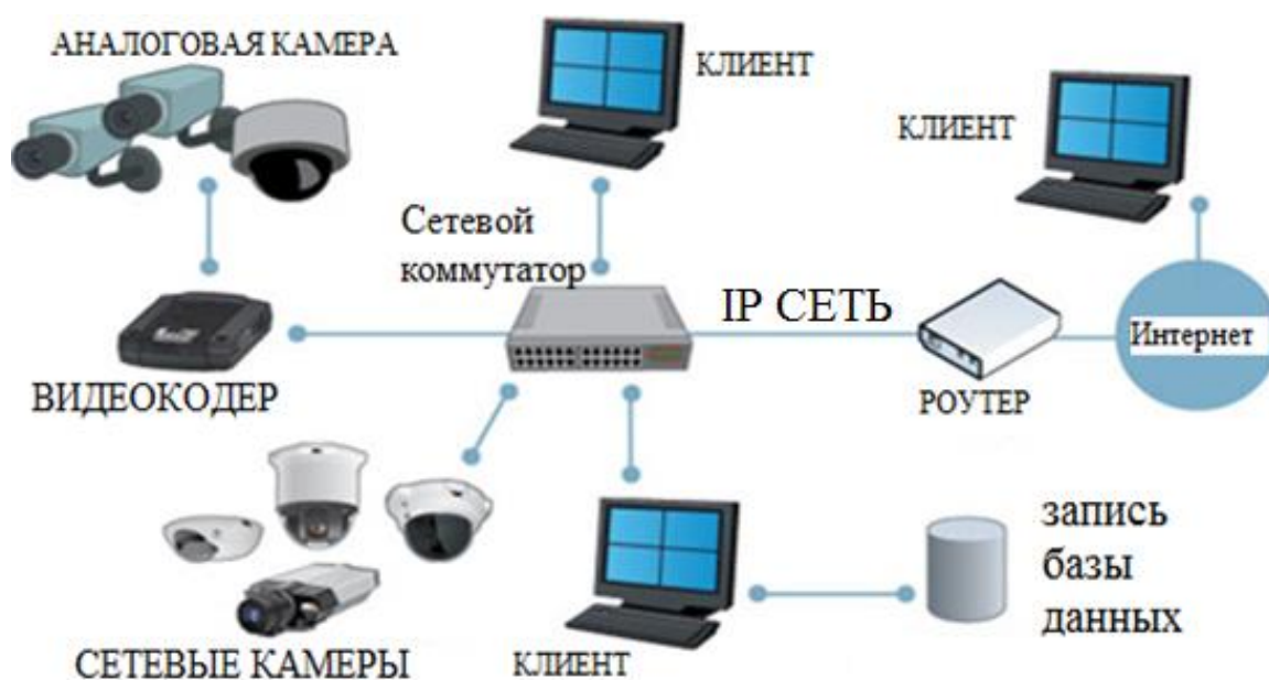
Рисунок 1.1 – Система сетевого видеонаблюдения, основанная на открытой платформе ПК-сервера с программным обеспечением для управления видео
