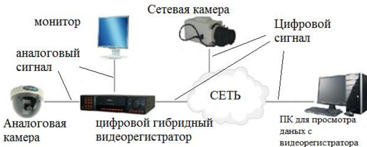
Рисунок 1.6 – Гибридная система видеонаблюдения
