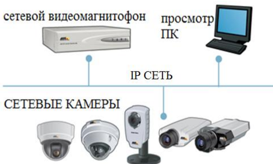
Рисунок 1.2 – Сетевая система видеонаблюдения, использующая NVR
