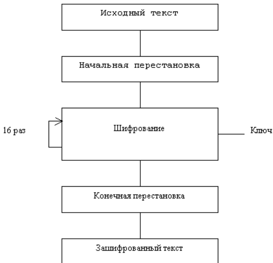
Рисунок 2 - Обобщенная схема шифрования в алгоритме DES
