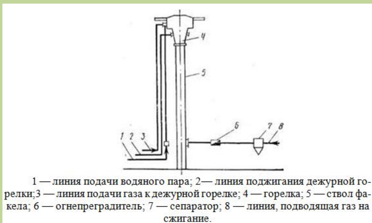
Рис. 3.3. Факельная установка
