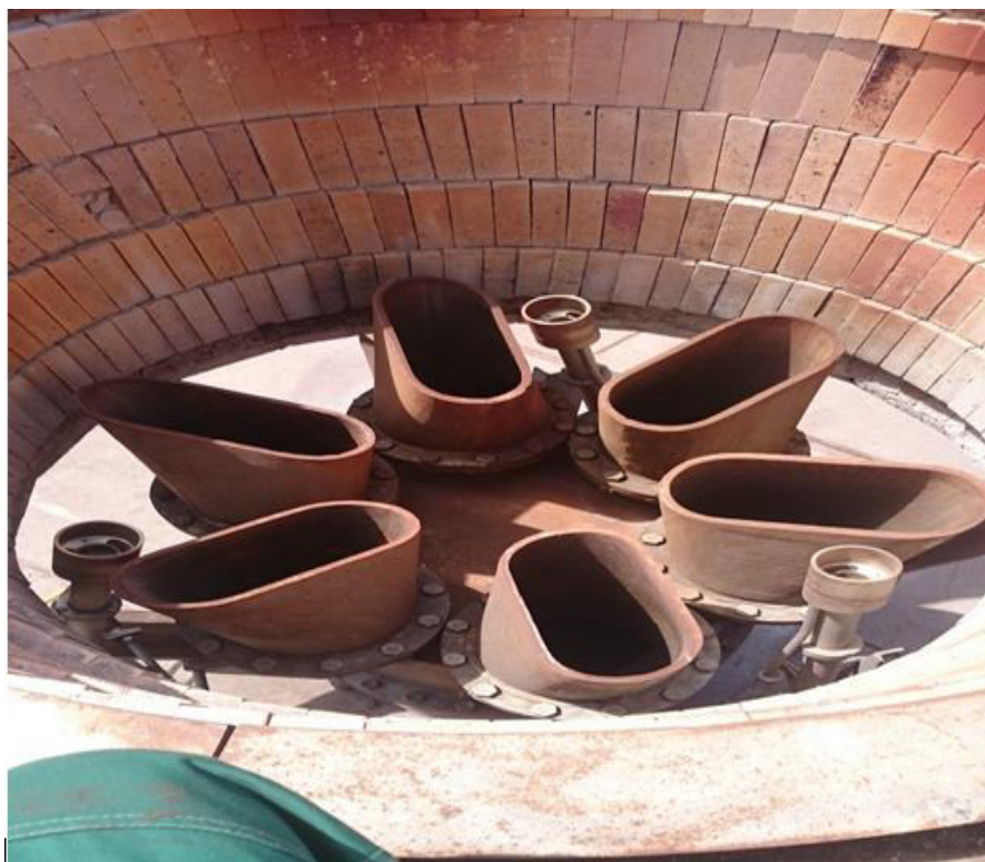
2.3 сурет - Текелі кенді қайта өңдеу кешеніндегі газ жағушы құрылғының қыздырғышы
