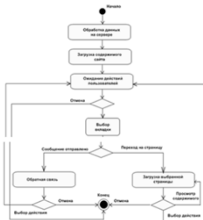
Рисунок 2.9 – Диаграмма состояний для вариантов использования, связанных с актёром "Пользователь"
