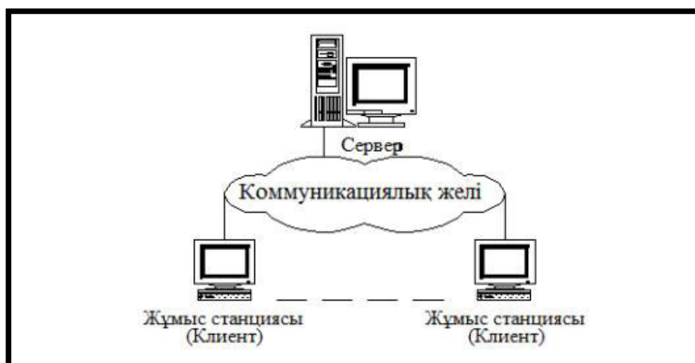
2.2-сурет – Клиент-сервер архитектурасы
