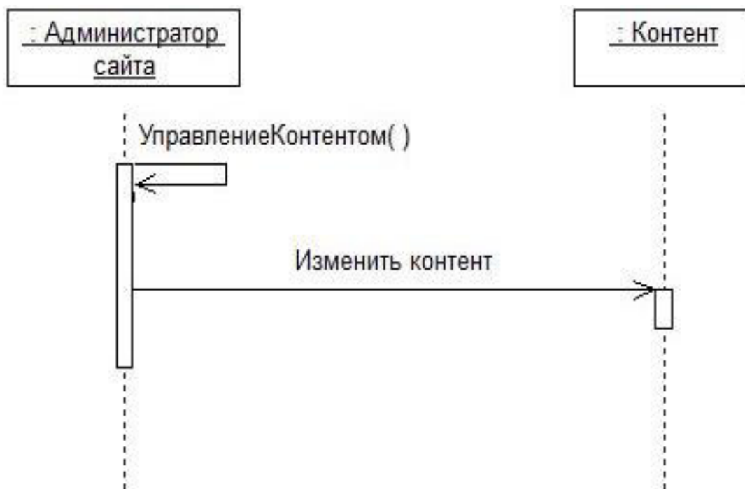
Рисунок 2.4 – Диаграмма последовательности управления контентом информационной системы
