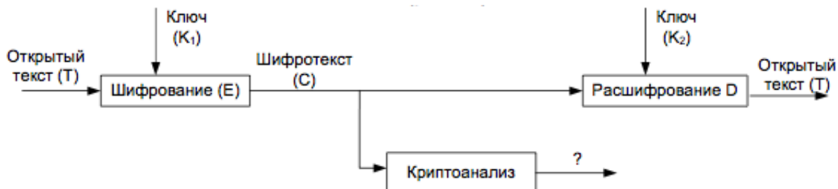
Рисунок 1.6 – Схема реализации пассивной криптоатаки
