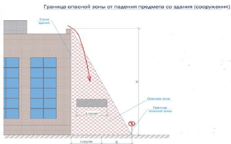
Рисунок 2.3 – граница опасной зоны от падения предмета со здания
