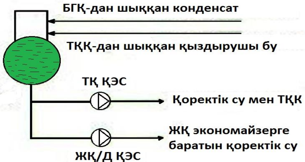
5.1.4 сурет – Деаэраторға жылулық баланс құру үшін
