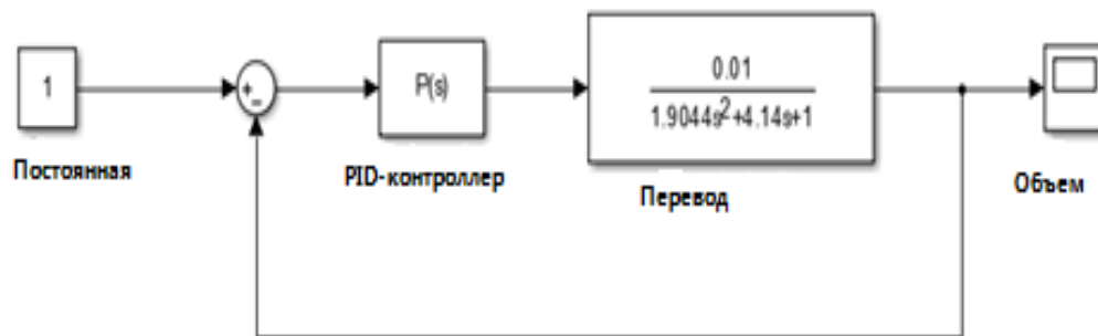
Рисунок 3.3 показана модель системы Simulink с P-контроллером
